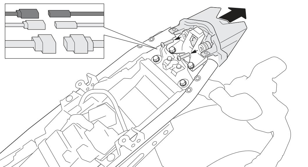
Lösen Sie die Steckverbindungen der Blinker und des Rücklichts.
