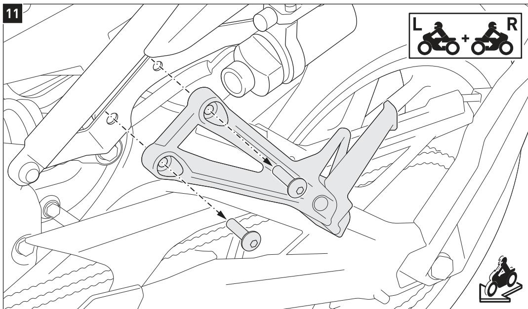
Entfernen Sie beidseitig die original Schrauben der Soziusfußrasten-Halter.
