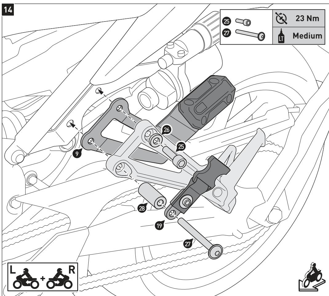
Verschrauben Sie die Anbaubleche (9) und Befestigungslaschen (19) mit den Soziusfußrastenhaltern am Fahrzeug, wie in der Zeichnung gezeigt.
