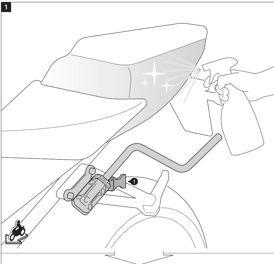
**DE** - Nachdem Sie die Abstandsbügel an Ihrem Fahrzeug montiert haben, müssen Sie die Auflageflächen der Satteltaschen mit der beigepackten Lackschutzfolie (2) bekleben, um Beschädigungen zu vermeiden. Reinigen Sie die zu beklebende Fläche vor dem Aufbringen der Lackschutzfolie gründlich von Fett- und Schmutzrückständen.
