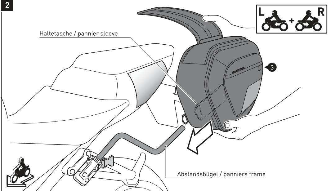
Schieben Sie anschließend die Haltetaschen der Satteltaschen (3) seitenweise über die zuvor montierten Abstandsbügel.
