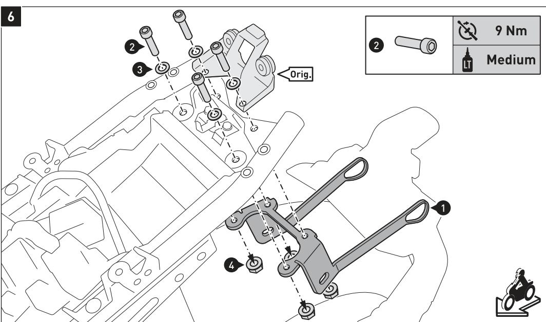
Verschrauben Sie das Blinkerverlegungsblech (1) mit der original Rücklichthalterung (Orig.) am Fahrzeug, wie in der Zeichnung gezeigt.
