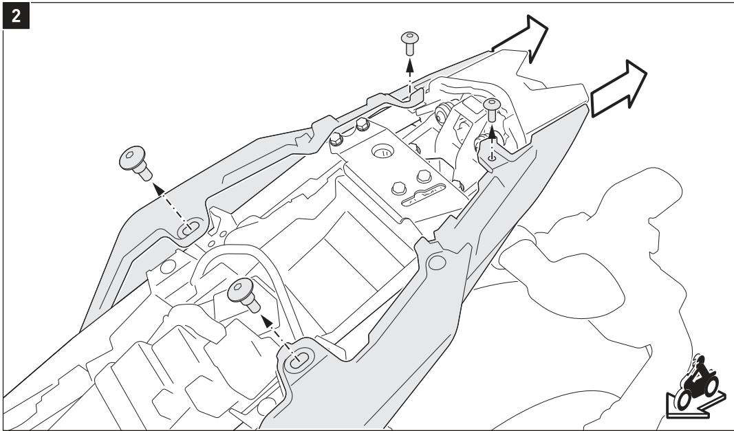
Lösen Sie die gezeigten Schrauben der hinteren Seitenverkleidungen.
