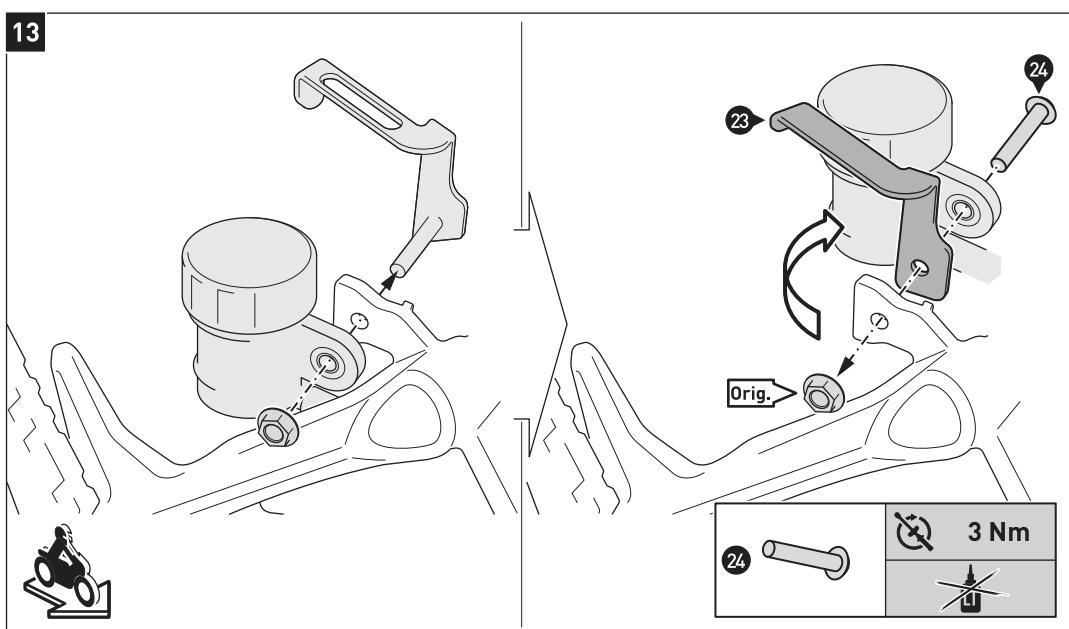
Entfernen Sie den Bremsflüssigkeitsbehälter vom rechten Soziusfußrastenhalter.
