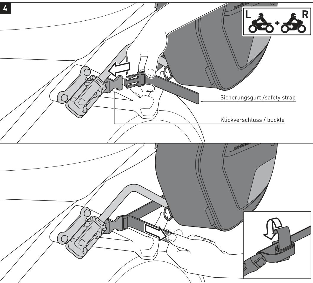
Rasten Sie nun die Sicherungsgurte der Satteltaschen (3) in die zuvor lose verschraubten Klickverschlüsse (1) ein. Ziehen Sie jetzt die Schrauben der Klickverschlüsse (1) an.
