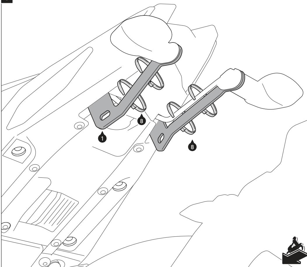
Fixieren Sie die Blinkerkabel mit den Kabelbindern (8) am Blinkerverlegungsblech (1).
