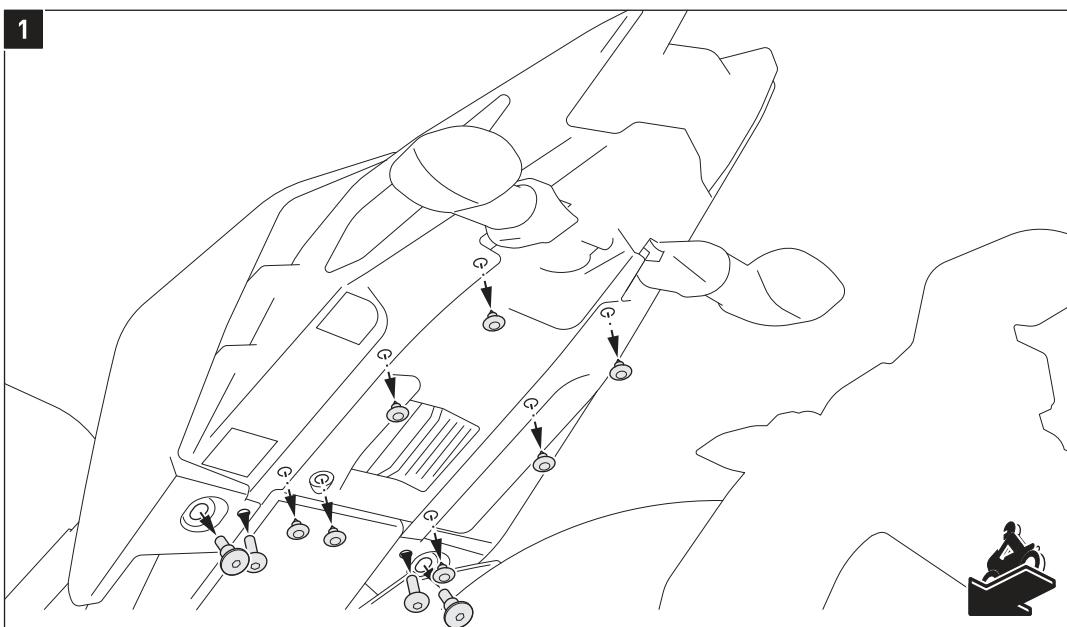
Lösen Sie die gezeigten Schrauben und Kunststoffdübel der hinteren Seitenverkleidungen.
