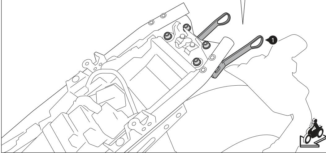
Trennen Sie die original Blinkerkabel in der Mitte durch.
